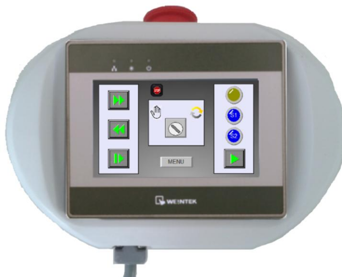
1.3. El cable de comunicación entre el servo accionamiento y la pantalla de 2 metros de largo.
